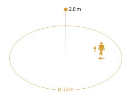
Hauteur d'instal lation: 2,50 m – 3,50 m Orange: sens de passage radial et tangentiel
